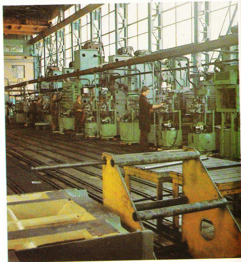
Сборка автоматических линий для обработки блока ▼ цилиндров автомобиля КамАЗ
